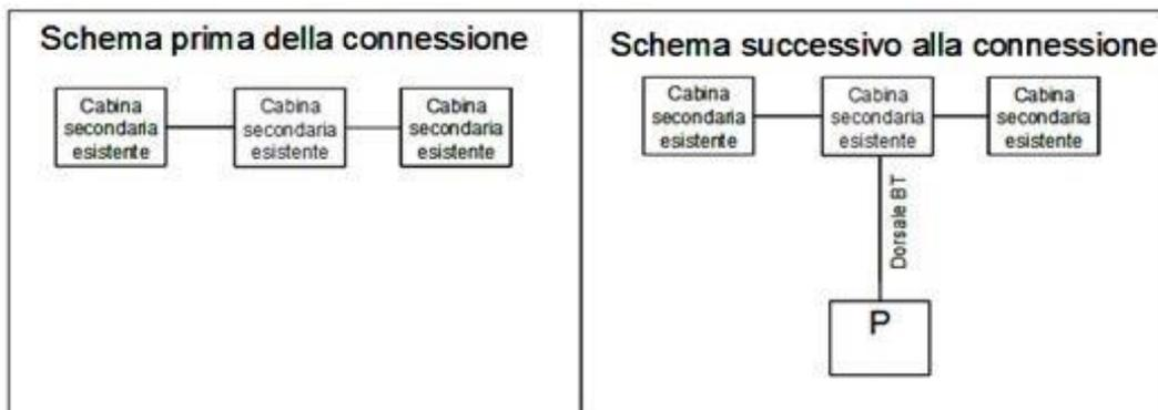
Figura 2 - Inserimento in antenna da cabina MT/BT
