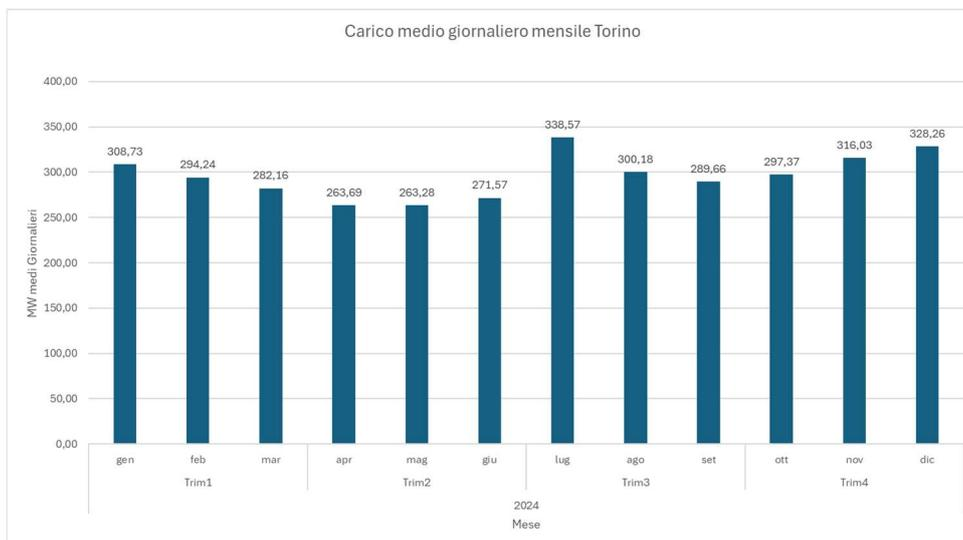
Figura 7 - Analisi del carico medio mensile 2024 (TO)
