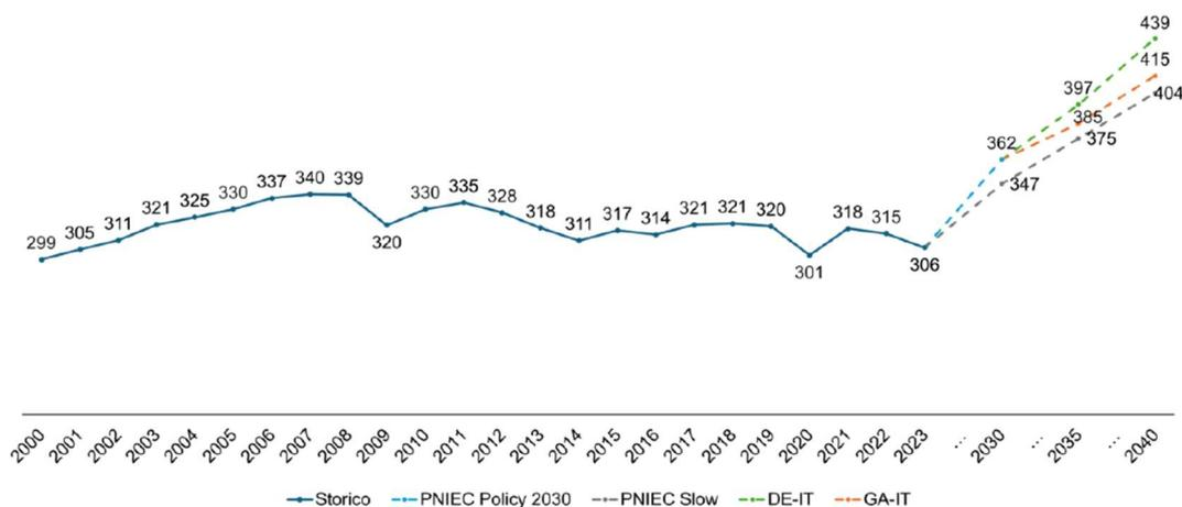
Figura 25 - Fabbisogno elettrico 2000 – 2040 [TWh] FONTE DDS 24
